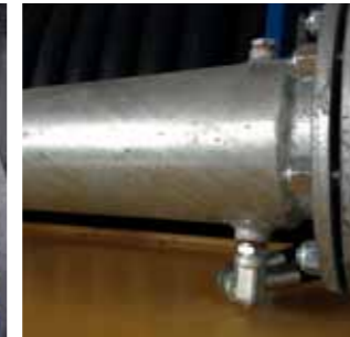
Raffreddamento olio per raccolta idraulica Oil-cooling system for hydraulic winding Système refroidissement huile pour enroulement hydraulique
